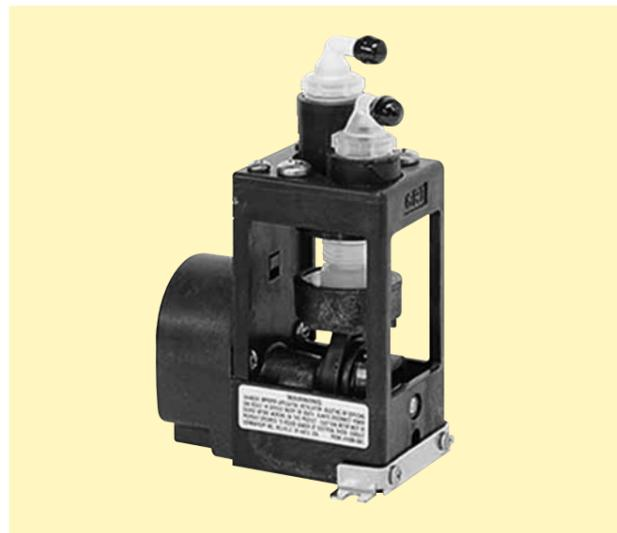
Le pompe dosatrici a soffierto Mini, sono state progettate e realizzate per tutte le applicazioni dove siano richieste basse portate e bassa pressione. Sono disponibili nella configurazione a soffierto singolo o in tandem fino ad un massimo di 4 soffierti in linea sullo stesso albero motore, con regolazione indipendente di ciascun soffierto attraverso un sistema meccanico azionabile solo a pompa ferma.
